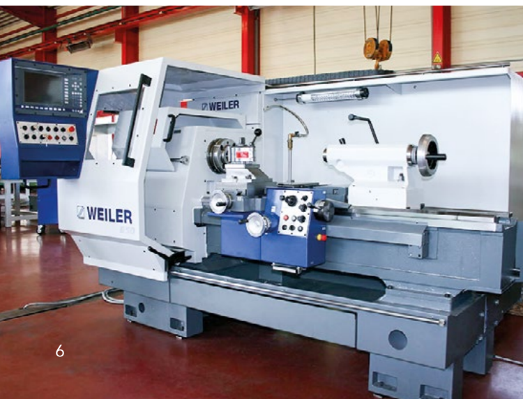
Zyklengesteuerte Drehmaschine WEILER E80 nach dem Retrofit
